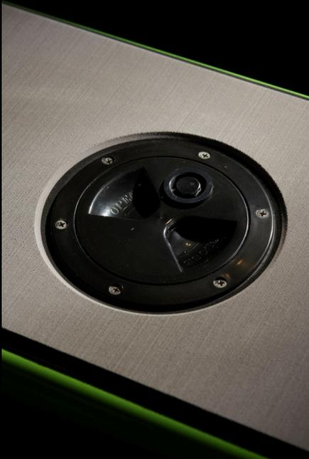
Entre la segunda y tercera bancada de cada flotador, la embarcación incorpora tapas de registro con válvulas Gore-Tex.
